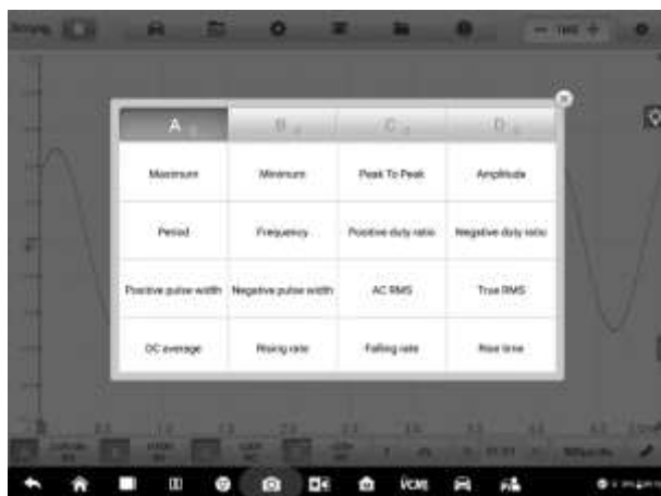
Рисунок 7-80. Первый пример окна выбора процедуры измерения
