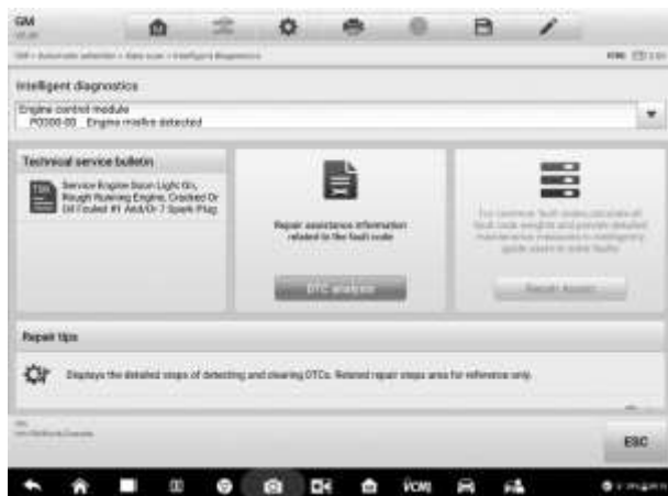
Рисунок 5-17. Пример окна бюллетеня технического обслуживания
