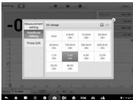
Рисунок 7-18. Пример окна настройки амплитуды (постоянное напряжение 2,0 В/дел)
