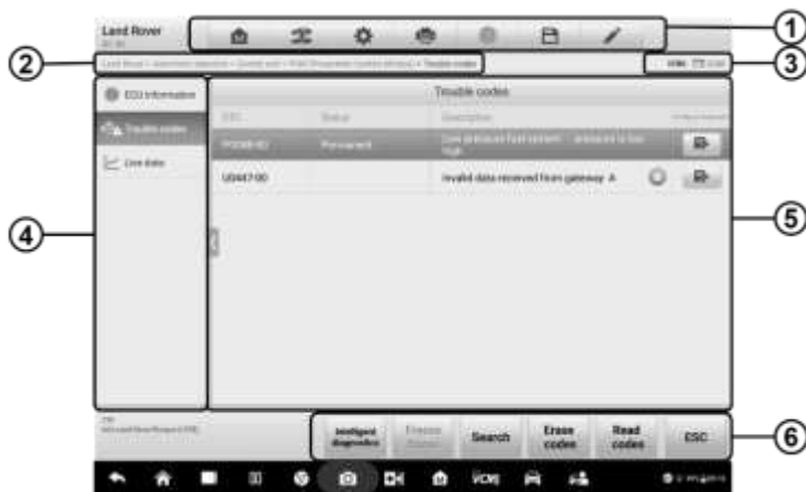
Рисунок 4-17. Пример окна считывания кодов
