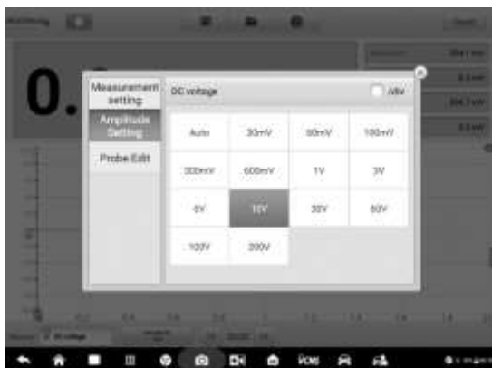
Рисунок 7-17. Окно настройки амплитуды (постоянное напряжение 10 В)
