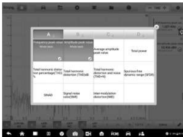
Рисунок 7-85. Пример окна настройки измерений (спектральное представление)
