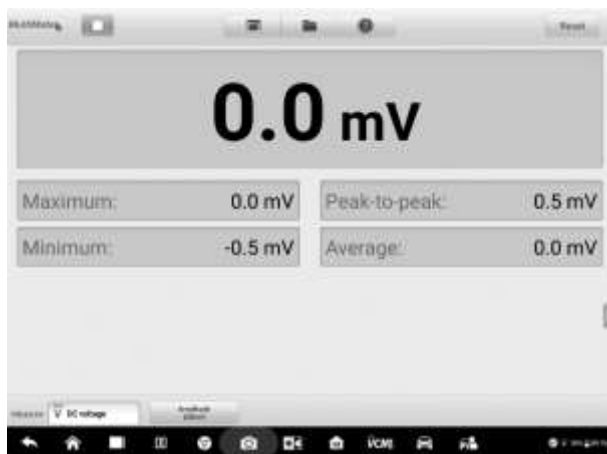
Рисунок 7-8. Пример окна с основной областью просмотра (цифровой режим)
