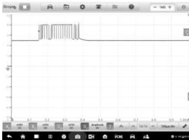
Рисунок 7-62. Второй пример окна настройки канала DLC
