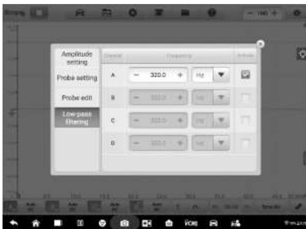
Рисунок 7-59. Пример окна настройки фильтрации нижних частот
