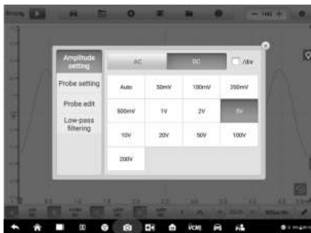
Рисунок 7-49. Пример окна настройки амплитуды (постоянное напряжение 5 В)
