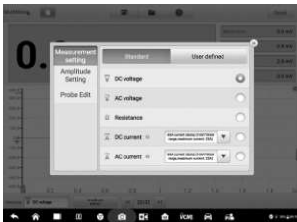
Рисунок 7-16. Пример окна настройки измерения
