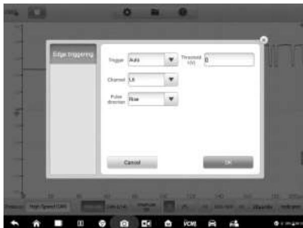
Рисунок 7-22. Пример окна, содержащего параметры запуска
