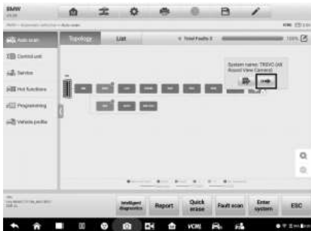
Рисунок 5-12. Пример окна со значком перехода к системе (окно Topology [Топология])
