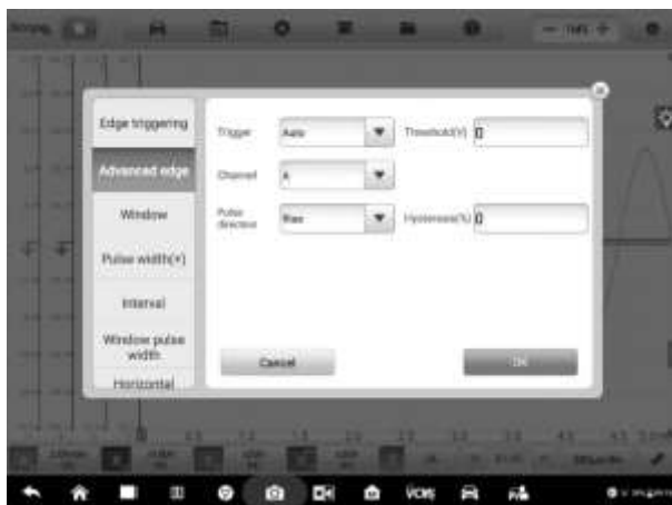
Рисунок 7-69. Пример окна параметров расширенного порогового запуска
