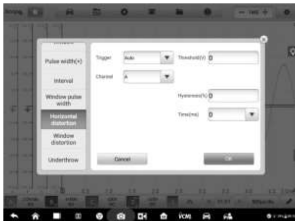
Рисунок 7-74. Пример окна параметров горизонтального искажения
