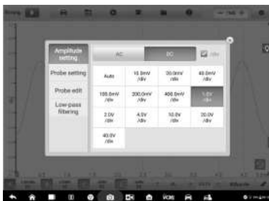
Рисунок 7-51. Пример окна настройки амплитуды (постоянное напряжение 1,0 В/дел)
