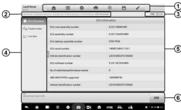
Рисунок 4-16. Пример окна, содержащего информацию об электронном блоке управления
