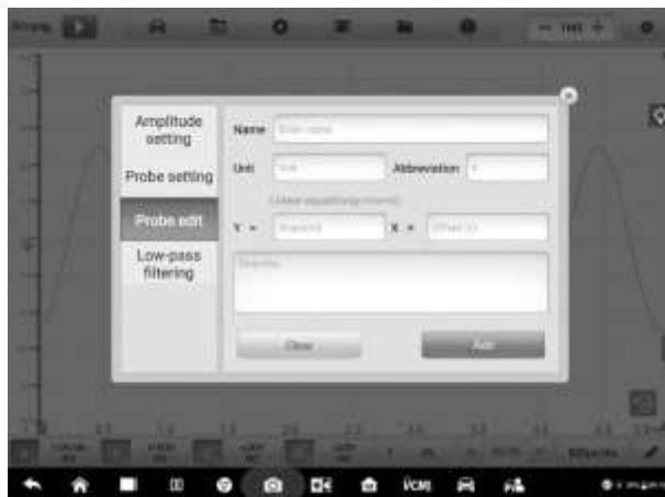
Рисунок 7-54. Первый пример окна изменения параметров щупа
