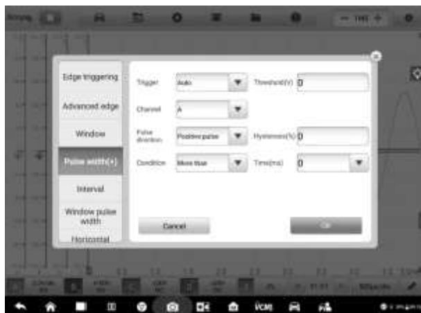
Рисунок 7-71. Пример окна параметров ширины импульса
