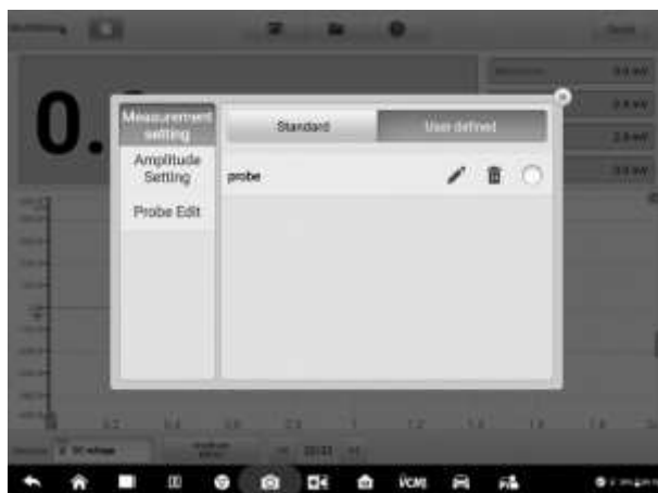
Рисунок 7-21. Третий пример окна изменения параметров щупа
