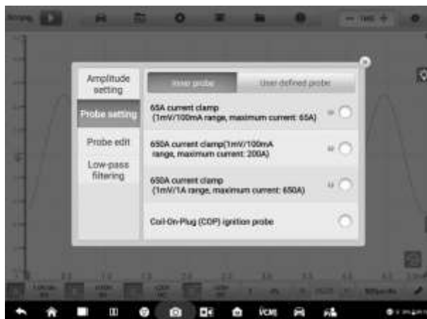
Рисунок 7-53. Пример окна настройки стандартного щупа
