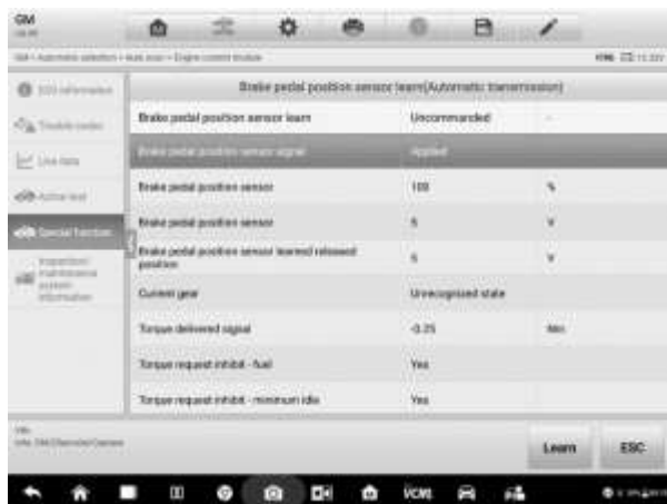
Рисунок 4-25. Второй пример окна специальных функций
