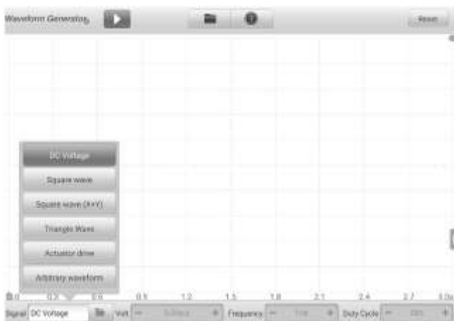
Рисунок 7-10. Окно настройки режима сигнала
