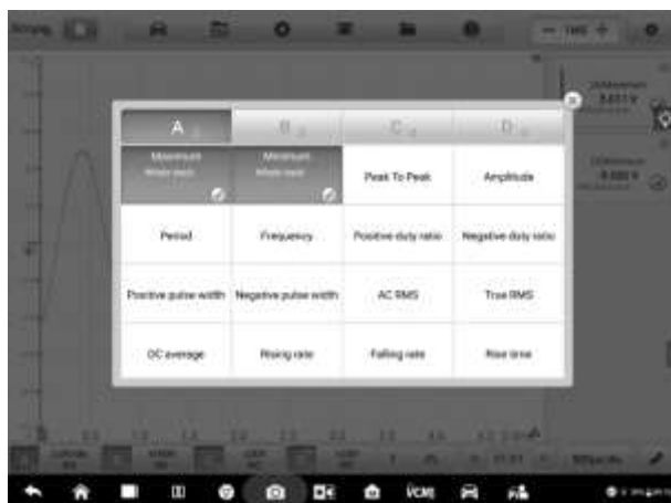
Рисунок 7-82. Пример окна настройки измерения
