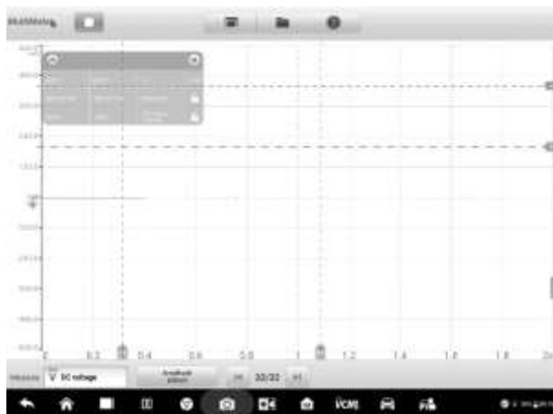
Рисунок 7-10. Пример окна, содержащего измерительные линейки
